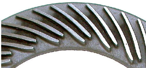
Die Bauweise der AEROROTOR®-Schaufeln verbessert Luftströmung und Kühlung, um dem Fading vorzubeugen.
