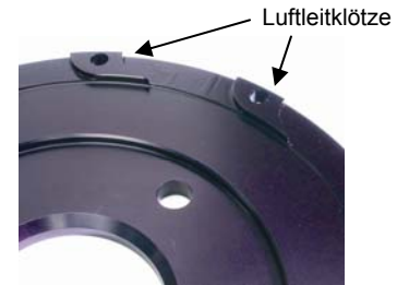
Der AEROHAT™ ermöglicht einen gleichmäßigen Luftstrom zwischen Brems scheibe und Brems scheibentopf, der die Außenseite der Brems scheibe kühlt, was bei anderen zweiteiligen Brems scheiben nicht der Fall ist.
