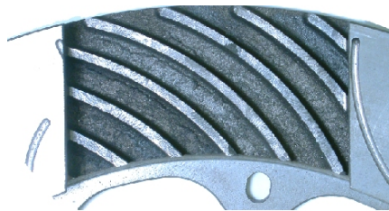
Bei dieser Brems scheibe eines Konkurrenzunternehmens wird durch Luftverwirbelung die an den Schaufeln entstehen, ein gleichmäßiger Luftstrom verhindert.
